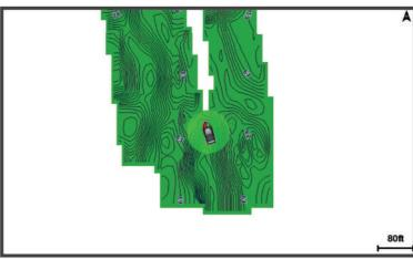
Зеленый круг обозначает хорошее качество регистрации глубины и высокую точность определения местоположения по GPS, а также скорость менее 16 км/ч (10 миль/ч). Желтый круг обозначает хорошее качество регистрации глубины и высокую точность определения местоположения по GPS, а также скорость в диапазоне между 16 км/ч и 32 км/ч (10 миль/ч и 20 миль/ч). Красный круг обозначает низкое качество регистрации глубины и точность определения местоположения по GPS, а также скорость более 32 км/ч (20 миль/ч).
