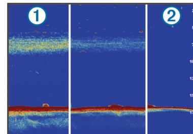
Растяжение эхосигнала и ширину фильтра можно использовать вместе для получения предпочтительного разрешения и уменьшения шумов. При установке низкого значения для растяжения эхосигнала и ширины фильтра изображение на экране имеет высокое разрешение, но является наиболее восприимчивым к шуму. При установке высокого значения для растяжения эхосигнала
