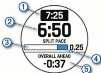
На экране устройства будет показан целевой темп на отрезке ①, текущий темп на отрезке ②, продвижение по отрезку ③, оставшееся расстояние на отрезке ④ и общее время опережения или отставания от целевого темпа ⑤.
