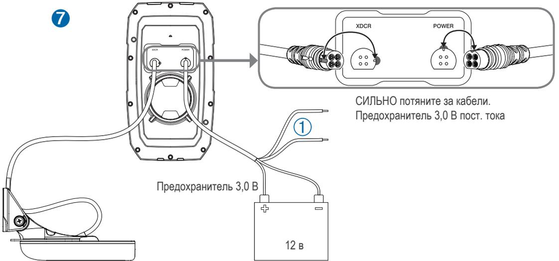
① Синий и коричневый провода необходимы только для обмена данными с другим устройством ECHOMAP™ или STRIKER.
